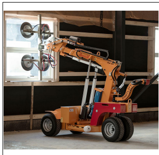
Smartlift SL408 bei der Fenstermontage
