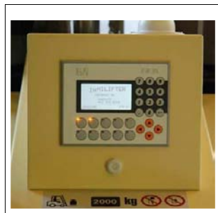
Bedienterminal des FTS-Gerätes
