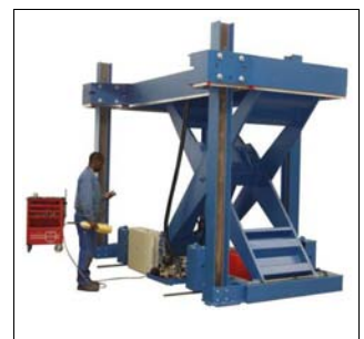
Prüftisch mit 10.000 kg Traglast
