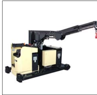
Kranwagen mit Quersitz-Fahrtrieb
