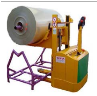
Elektro-Hochhubwagen mit Tragmulde
