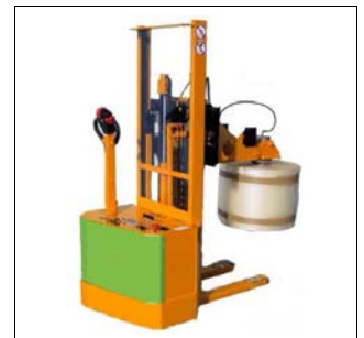
Elektro-Hochhubwagen mit Rollenmanipulator
