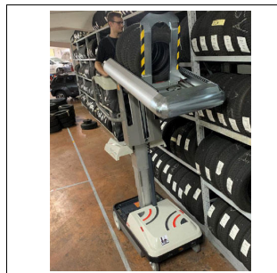
Kommissioniergerät für Reifen
