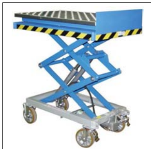
Hubwagen mit Kugelplattform
