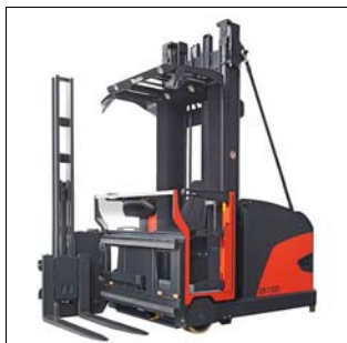
Schmalgangstapler für Lasten bis 1.100 kg
