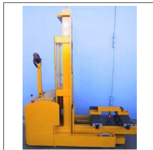
Elektro-Hochhubwagen mit Teleskopgabeln
