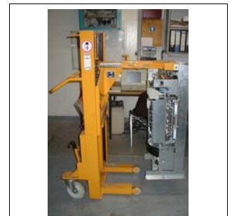
Hochhubwagen zur Schaltschrankmontage
