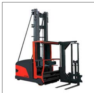
Schmalgangstapler für Lasten bis 2.000 kg
