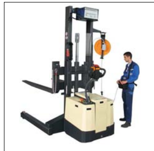
Breitspur-Hochhubw. mit Kabelfernbedienung
