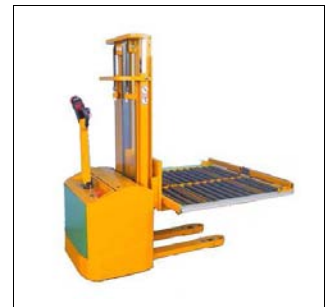
Elektro-Hochhubwagen mit Doppelrollenbahn
