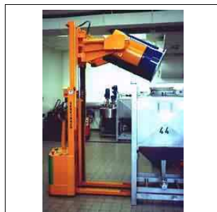
Elektro-Hochhubwagen mit Fasskipper
