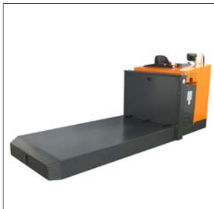
Schwerlast-Quersitz- Niederhubwagen (19 to)
