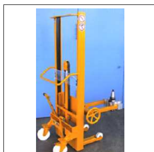
Hochhubwagen mit Werkzeugwechsler
