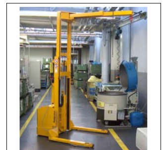
Elektro-Hochhubwagen mit schwenkbarem Kran
