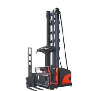
Schmalgangstapler für Lasten bis 1.300 kg
