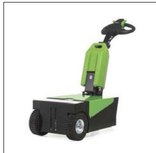
T1500-D Zugkraft bis 1.500 kg
