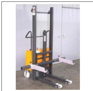
Hochhubwagen mit Rohrgreifer
