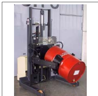
Elektro-Hochhubwagen mit Fasskipper
